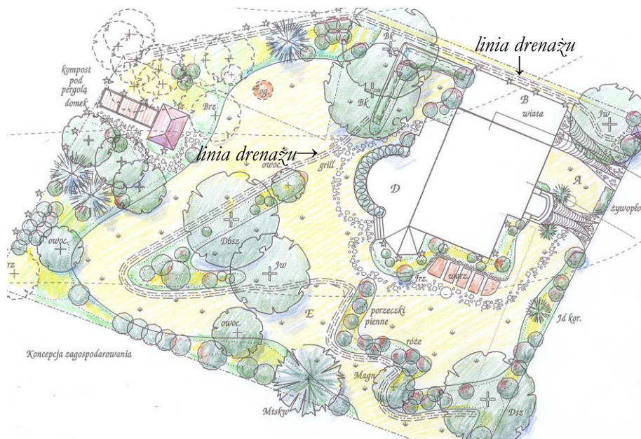
Rys. 7 Powierzchniowy drenaż francuski w ogrodzie położonym na stoku kemu
